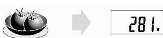
Après la pesée, pressez la touche „OFF/TARE“ et le système revient à l'indication de l'heure. Au bout de 60 secondes de non-utilisation, le système revient automatiquement au mode d'affichage de l'heure.
