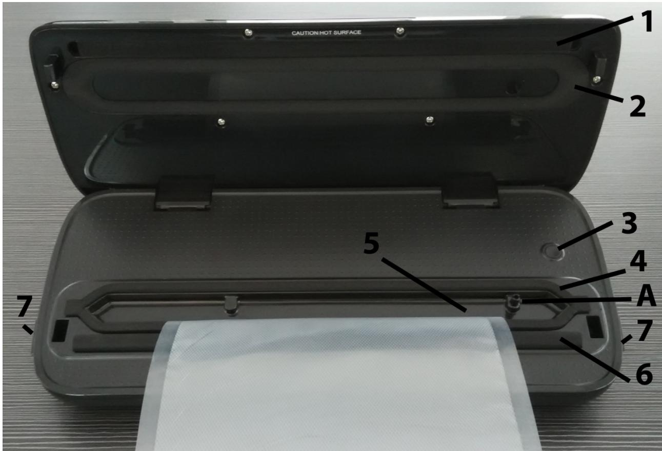
1 las **barras selladoras**, con los filamentos calentadores recubiertos de teflón. Esto permite sellar las bolsas sin que se peguen a las barras.
